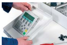
Установка устройства в крышку
